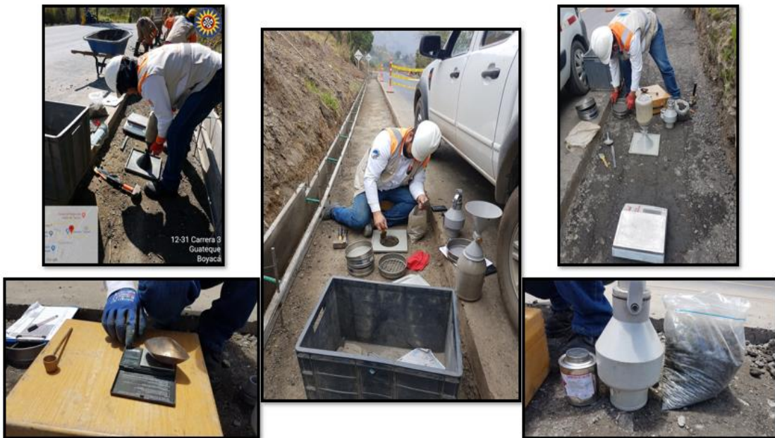
Fotografía 2. Ensayos para determinar densidad y humedad de suelos.
