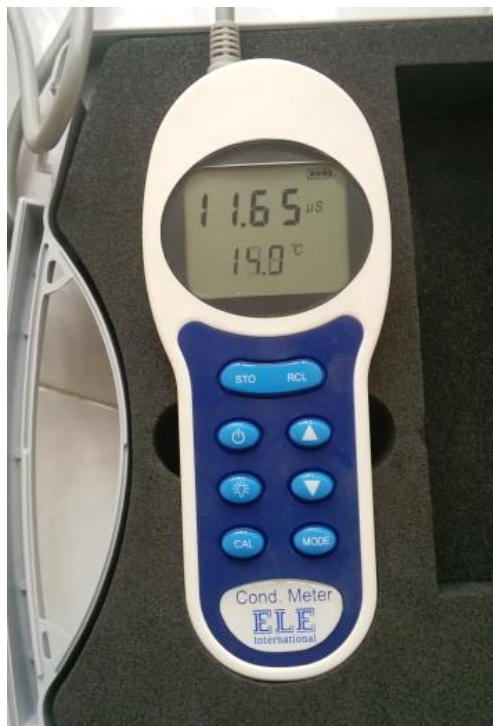
Figura 5. Medición de Temperatura, conductividad y SDT a las muestras a través del conductivimetro
