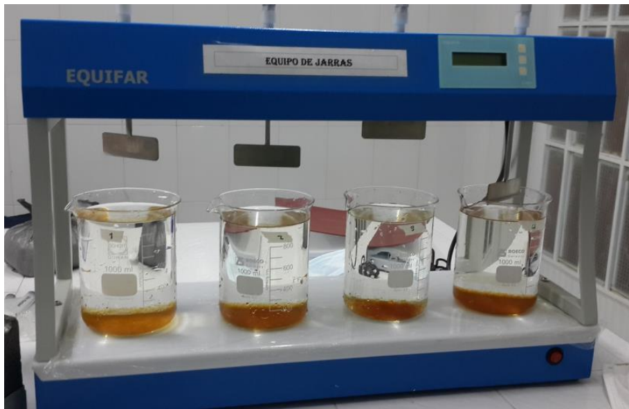
Figura 8. Proceso de sedimentación
