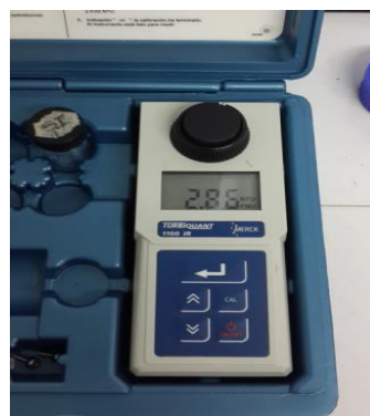
Figura 1. Medición de turbiedad mediante turbidímetro referencia 100T
