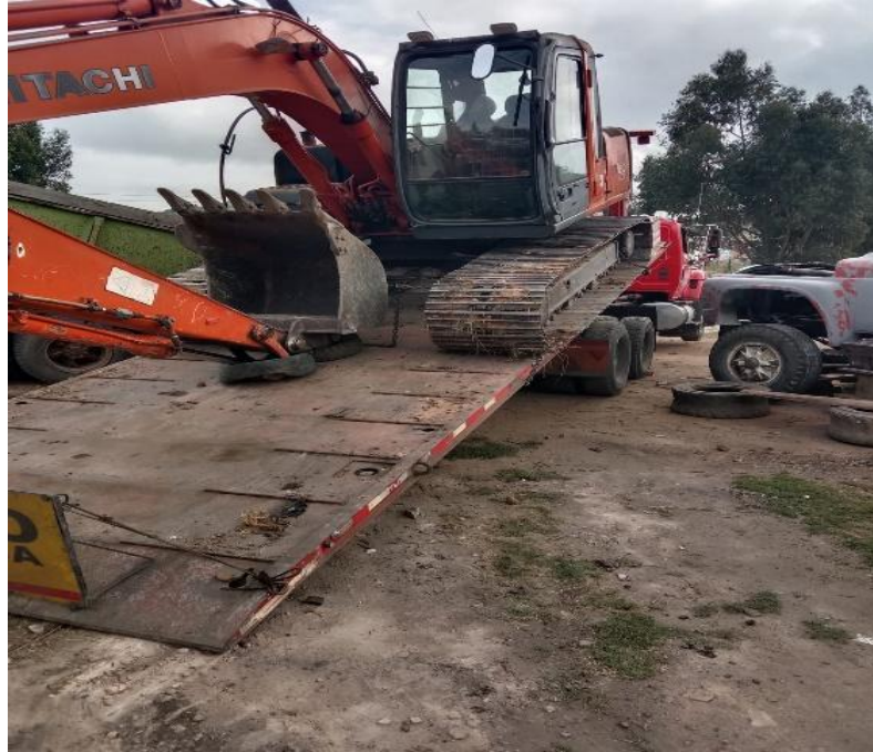
Ilustración 15. Excavadora Hitachi de orugas
