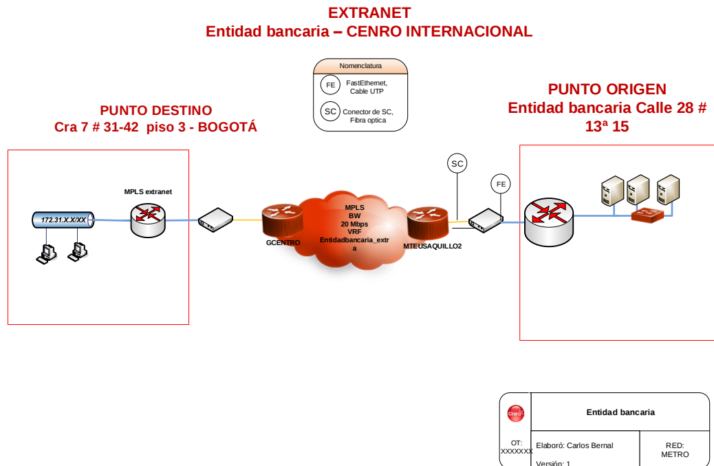
Ilustración 81. Diagrama de ingeniería extranet entidad financiera punto origen – Sede Remota (antes).
