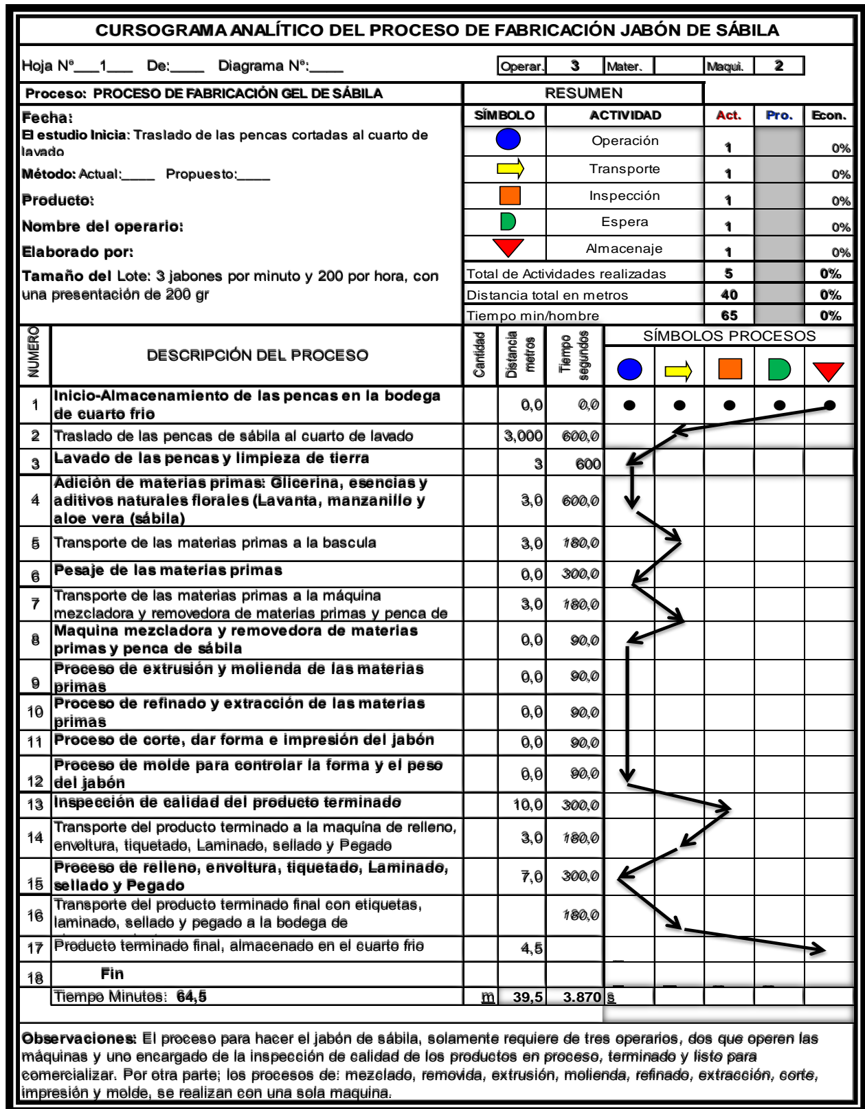
Figura 21. Estudio de tiempos y movimientos-Proceso fabricación jabón de sábila
