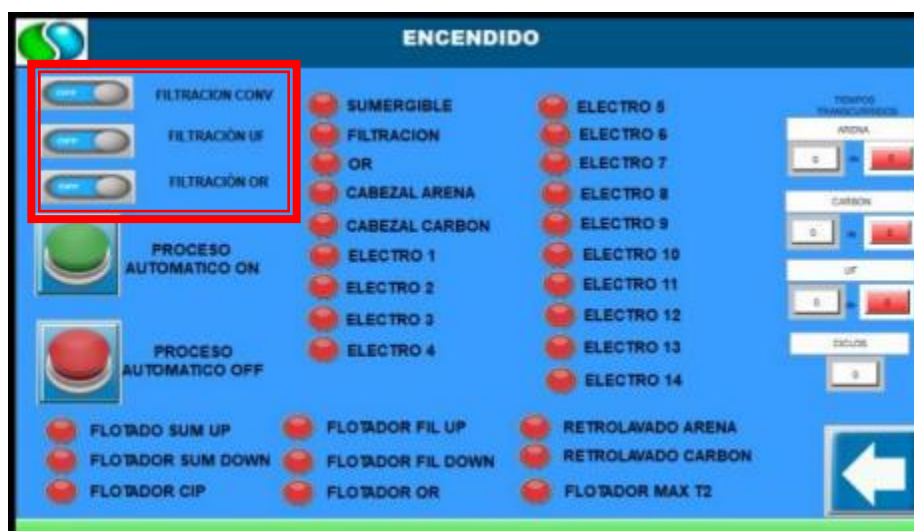
Ilustración 3: Menú principal tablero de control PTARnD
