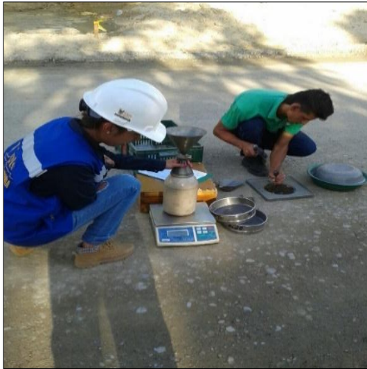
FOTO 1: TOMA DE MUESTRAS Y ENSAYO DENSIDADES PARA BASE
