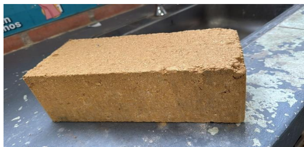
Ilustración 43. Secado Bloques de Tierra Comprimida Fuente: Autoría Propia
