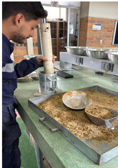
Ilustración 36: Ensayo Proctor Fuente: Autoría Propia
