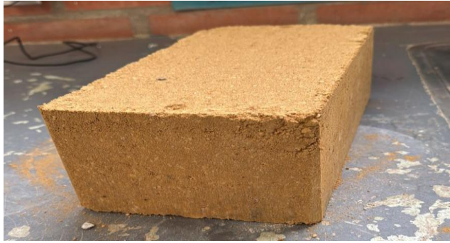
Ilustración 44. Secado Bloques de Tierra Comprimida Fuente: Autoría Propia
