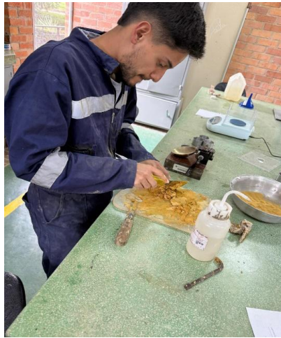
Ilustración 31 Consistencia y plasticidad de suelos: límite líquido y límite plástico Fuente: Autoría Propia
