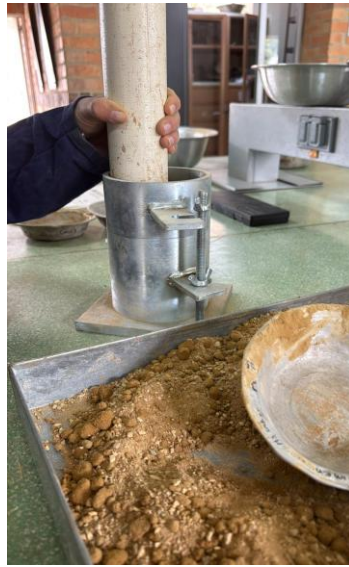
Ilustración 37 Ensayo Proctor Fuente: Autoría Propia
