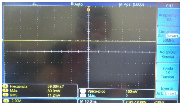
Figura 11. Señal telefónica del voltaje de timbre.
