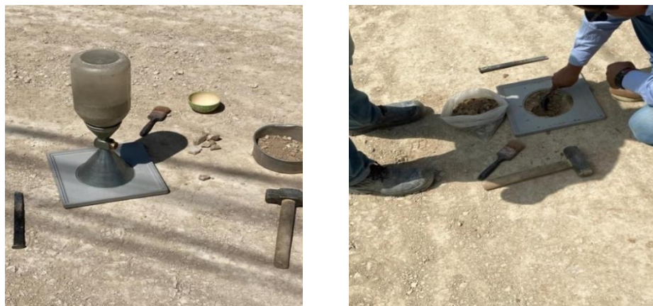
Figura 28. Ensayo método de cono de arena tramo 1
