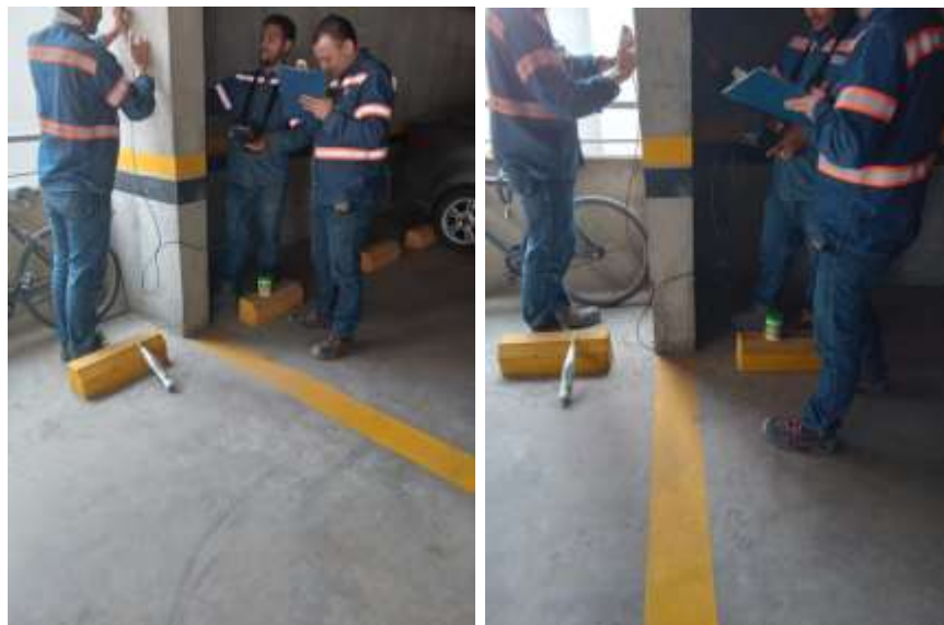
Personal del laboratorio SGS en el ensayo de ultrasonido.
