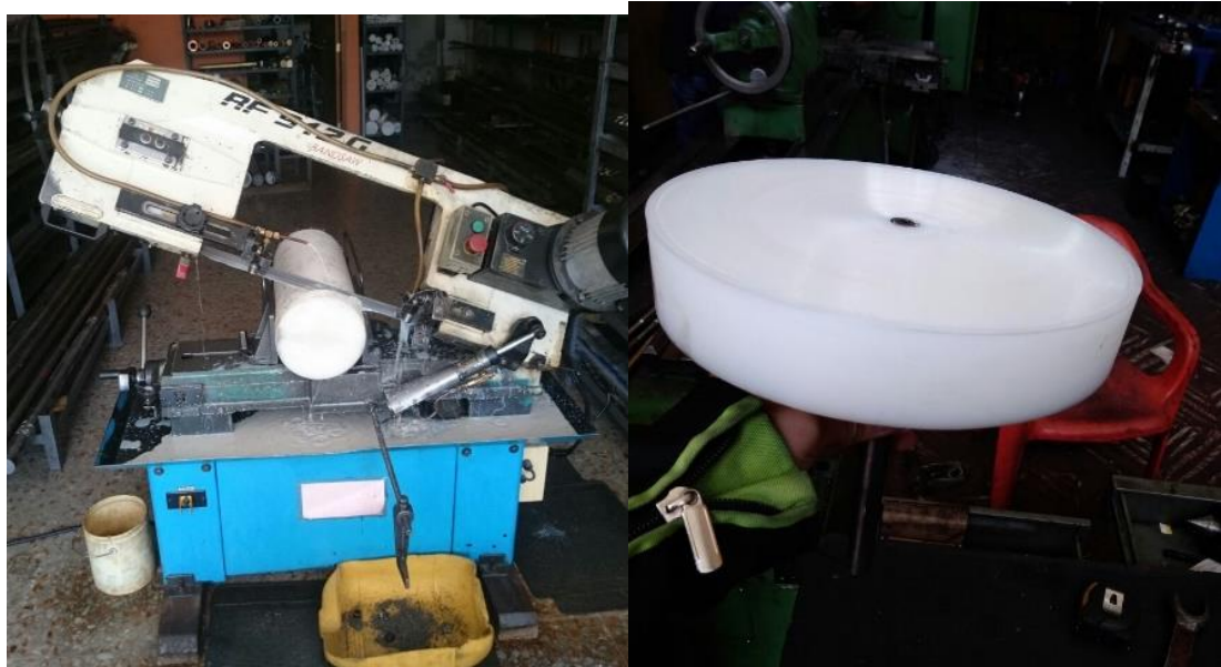
Figura 42. Corte, maquinado y taladrado de discos de teflón.
