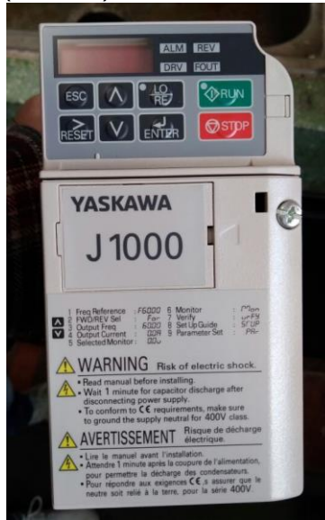
Figura 25. Variador de frecuencia (1 unidad)
