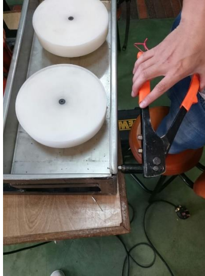
Figura 41. Fijación del platero con remaches
