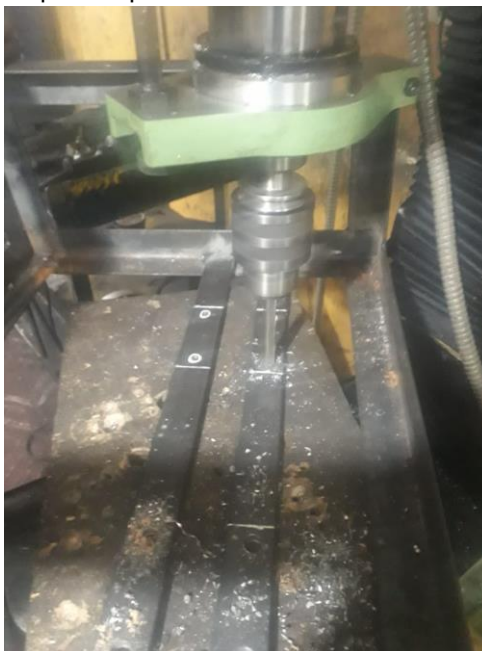
Figura 35. taladrado de platinas para soportes.
