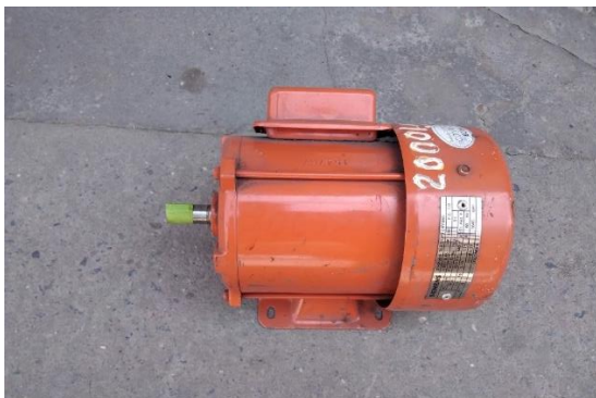
Figura 24. Motor eléctrico trifásico 0,6hp (1 unidad).
