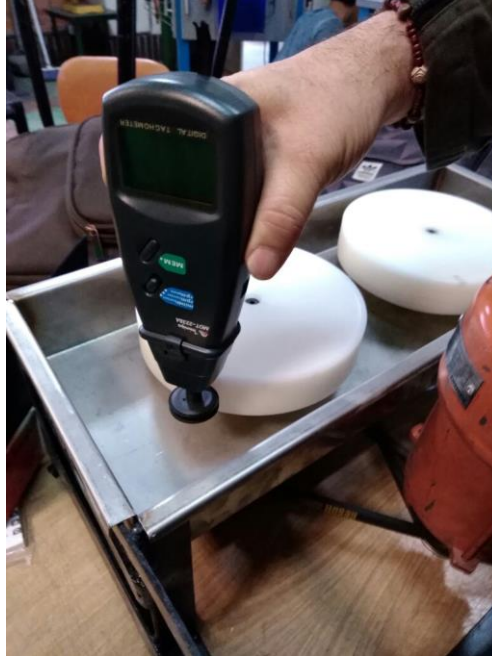
Figura 57. Prueba de velocidad disco 2, utilizando tacómetro.
