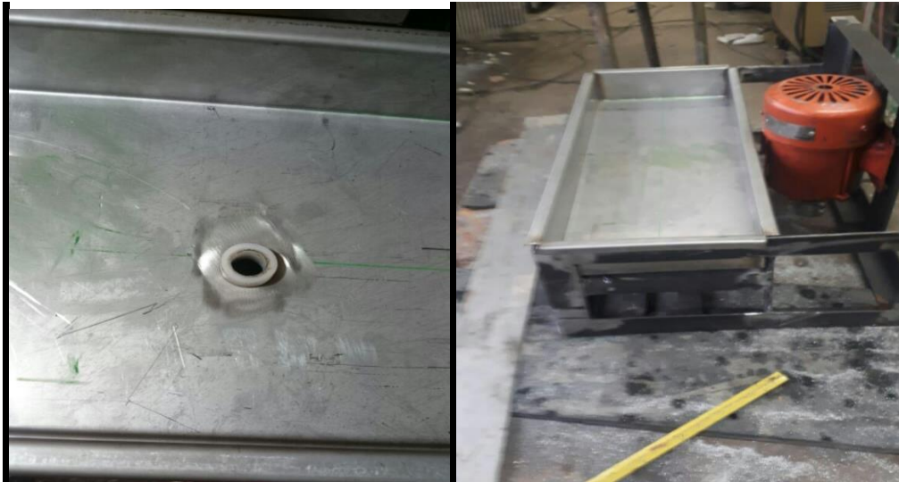
Figura 40. Doblado y perforado del platero
