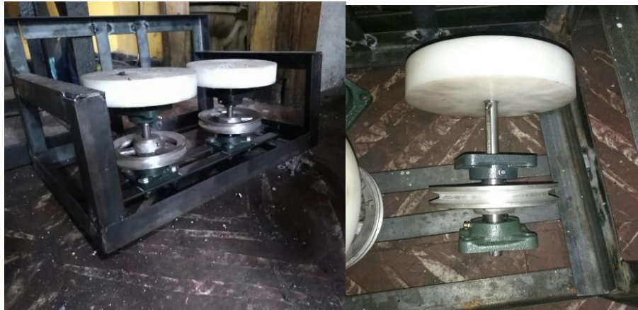
Figura 38. Fijación ejes con chumacera y poleas con ejes.
