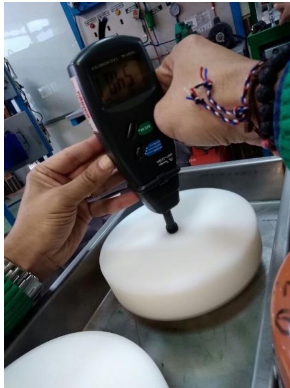
Figura 56. Prueba de velocidad disco 1, utilizando tacómetro
