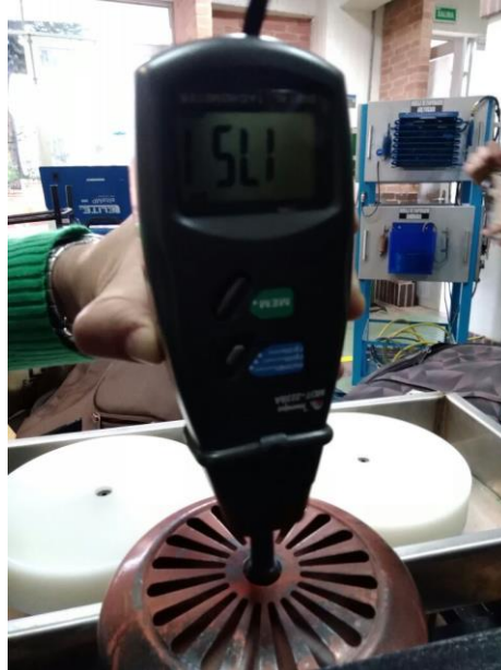
Figura 55. Prueba de velocidad de salida del motor, utilizando tacómetro.
