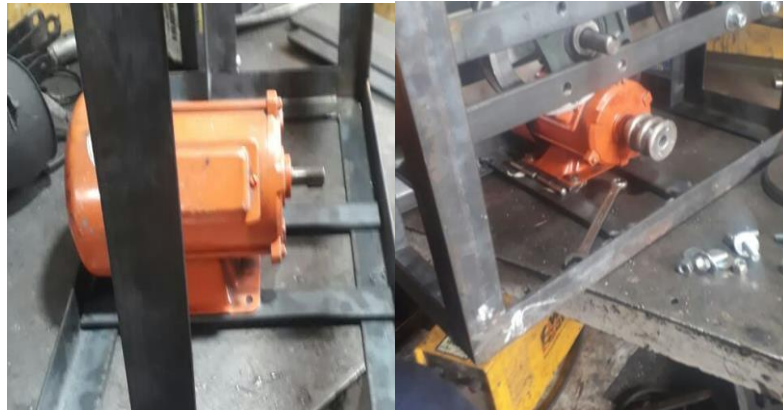
Figura 37. fijación del motor.
