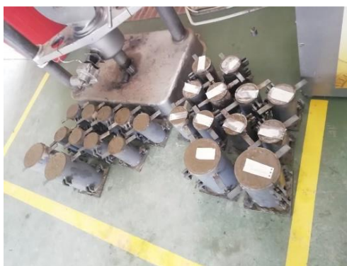
Figure 2 Muestras realizadas de concreto Fuente: Autor
