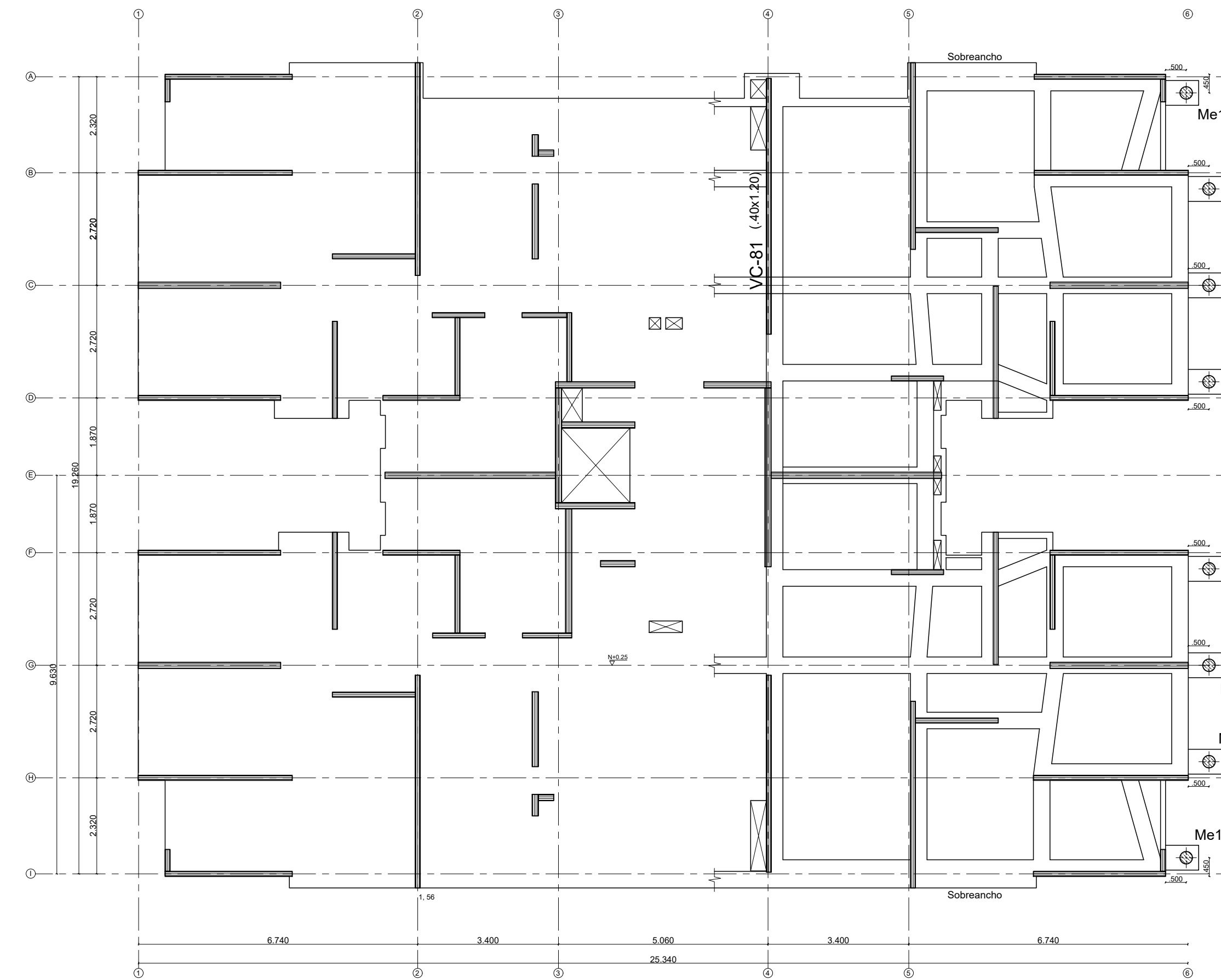
Todos los pilotes Ø=0.30, L=35 m. RINCÓN DE LA ALAMEDA TORRE 4 PLANTA 1er PISO (CIMENTACIÓN) Pilotes adicionales Esc.: 1/100
