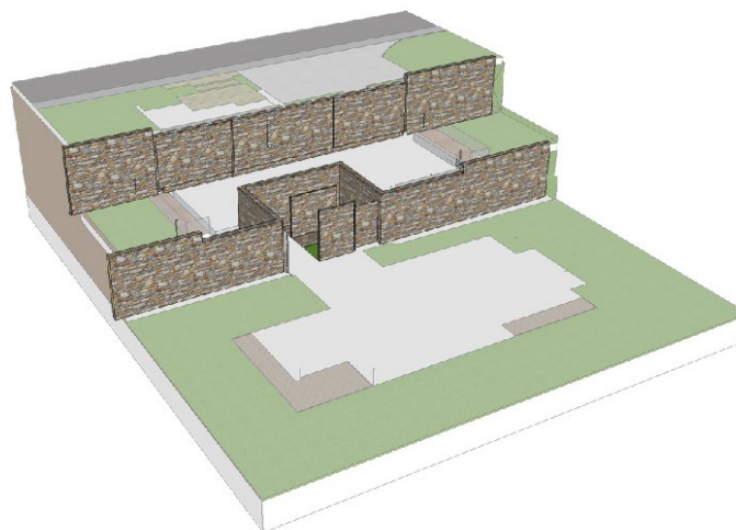
Figura 64. Perspectiva de muro de contención
