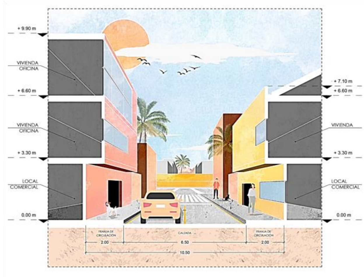
Figura 103. Plano de la intervención zona B, perfil
