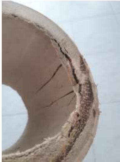
Figura 11.23- Probeta Fallada Ensayo Compresión Paralelo a Las Fibras
