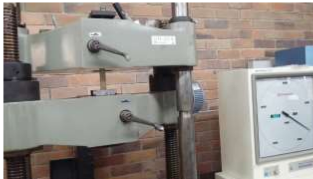
Figura 11.35- Ensayo de Tracción Paralela a la Fibra
