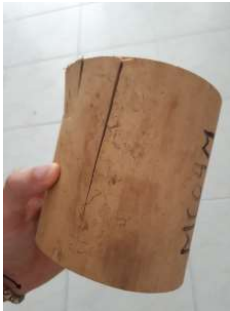
Figura 11.24- Probeta Fallada Ensayo Compresión Paralelo a Las Fibras
