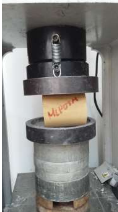
Figura 11.29- Probeta Fallada Ensayo Compresión Perpendicular a Las Fibras
