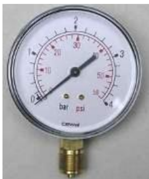
Imagen 78 Manómetro de doble escala. Termopaipa
