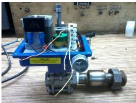
Imagen 23 Electroválvula para desalojo de condensado
