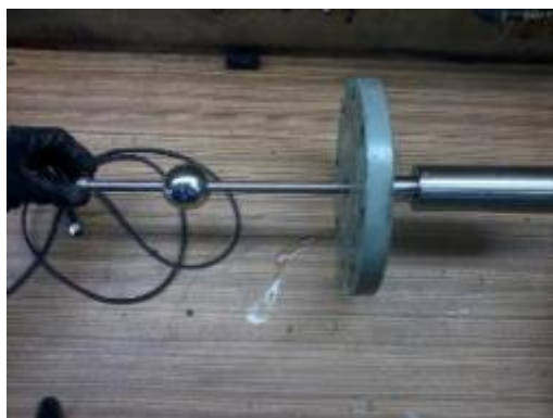
Imagen 22 Cuerpo del sensor magneto restrictivo.
