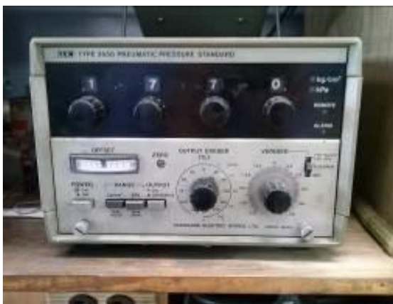
Imagen 35 Generador de presión (Max 2 kg/cm 2 )
