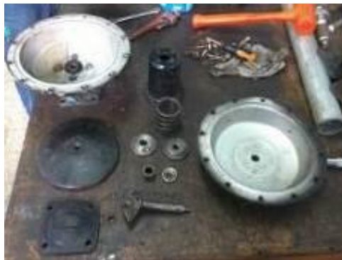
Imagen 109 Desarme de una válvula tipo Saunders
