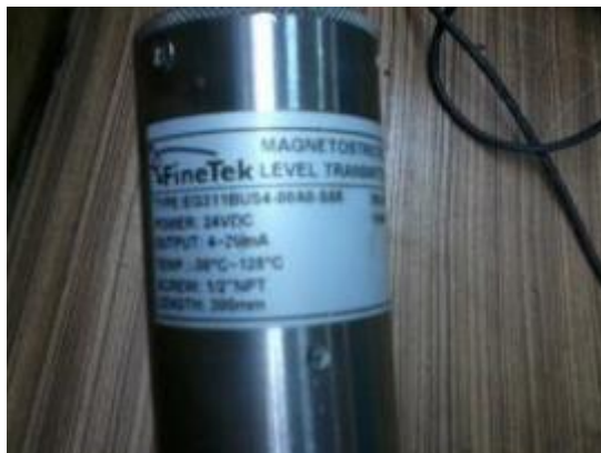
Imagen 21 Placa de características Sensor de nivel.
