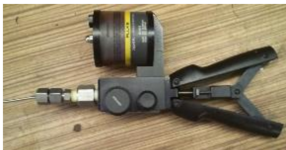
Imagen 33 Módulo generador de altas presiones Fluke 700HTP1
