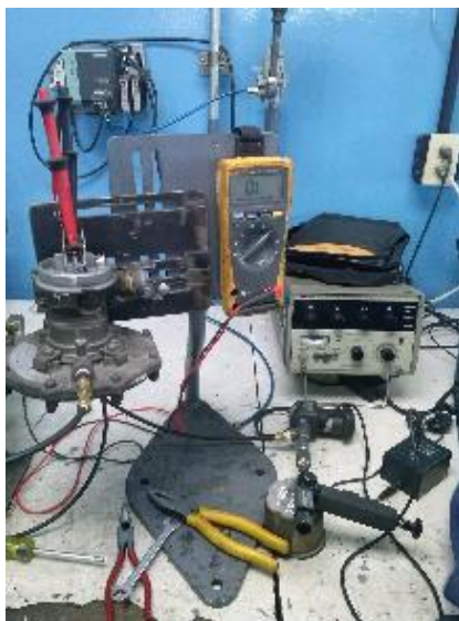
Imagen 27 Verificación switch de presión
