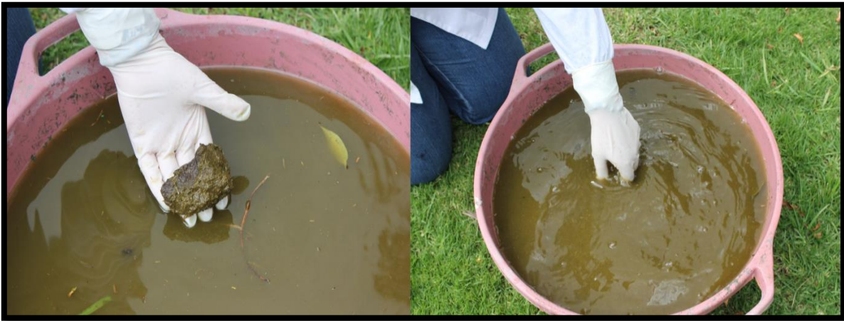
Ilustración 23. Mezcla para la determinación de coliformes totales y parámetros in-situ
