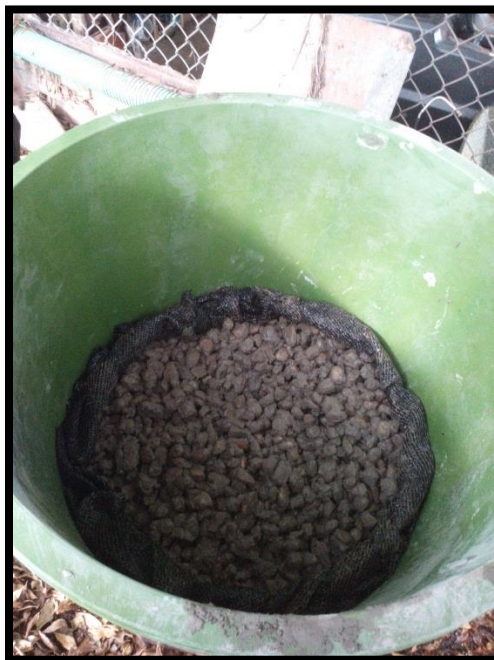
Ilustración 22. Montaje final sistema con antracita
