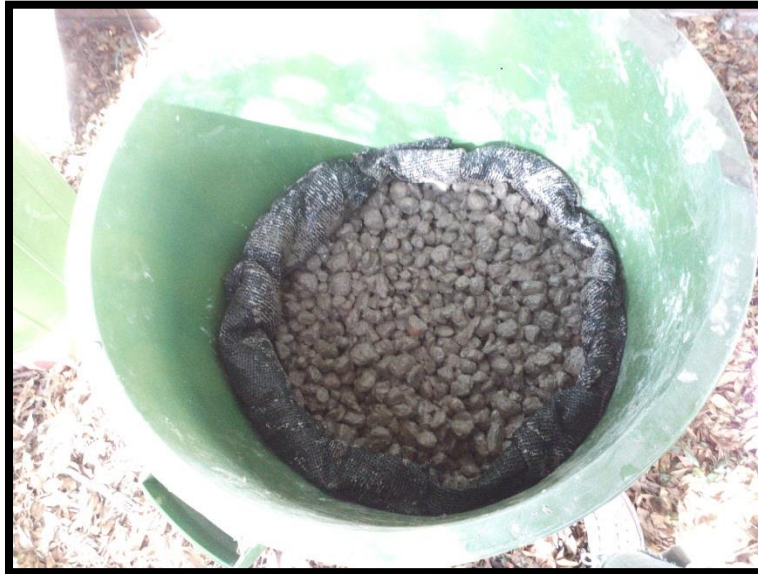
Ilustración 21. Montaje final Carbón Activado
