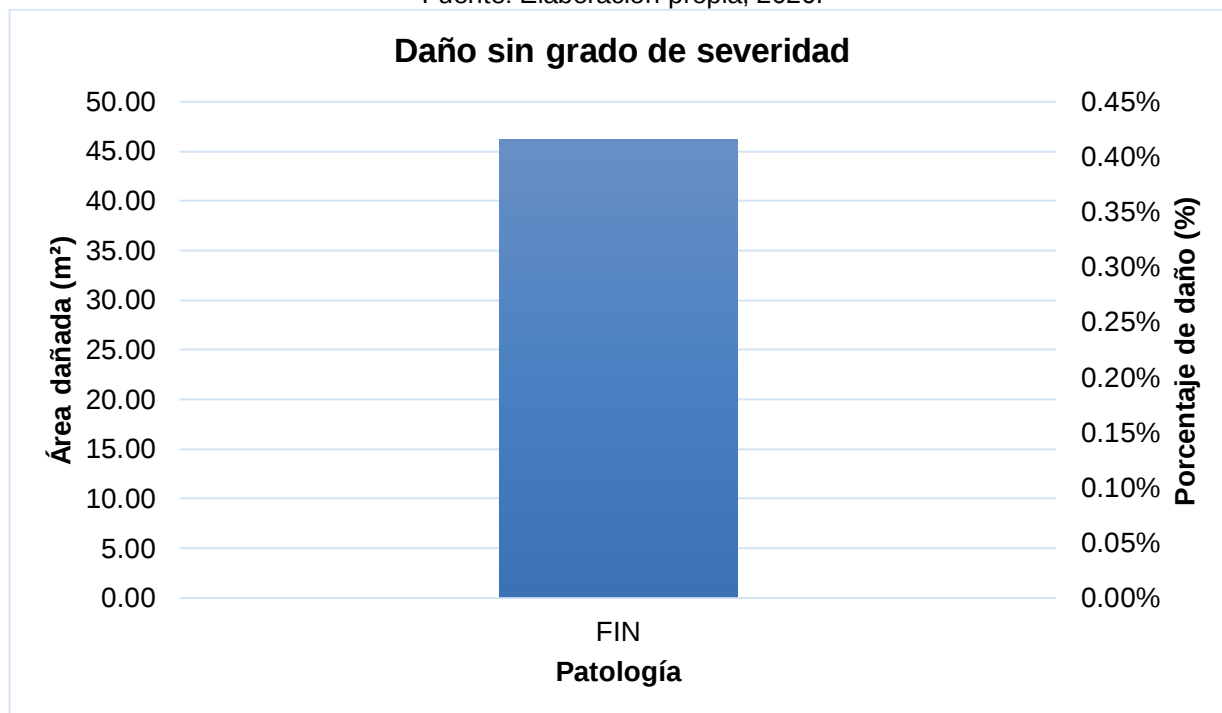
Gráfica 9. Área de afectación vs Porcentaje de afectación sin grado de severidad, daños en el pavimento sin incluir daños superficiales.
