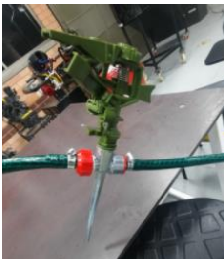
Figura 46. Conexión aspersores. Fuente: Autores.
