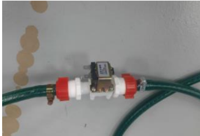
Figura 44. Conexión electroválvula. Fuente: Autores.
