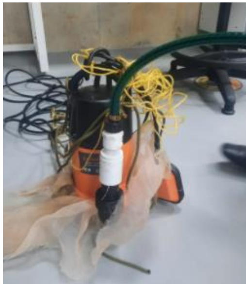
Figura 45. Conexión acople electrobomba sumergible. Fuente: Autores.
