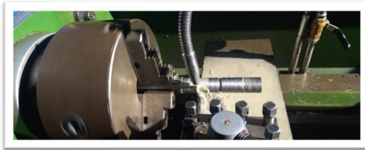
Figura 8.16 Proceso de desbaste y cilindrado de la pieza.
