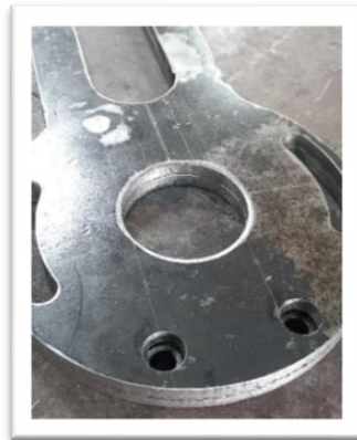
Figura 8.22 Inspección de ranuras y agujeros.
