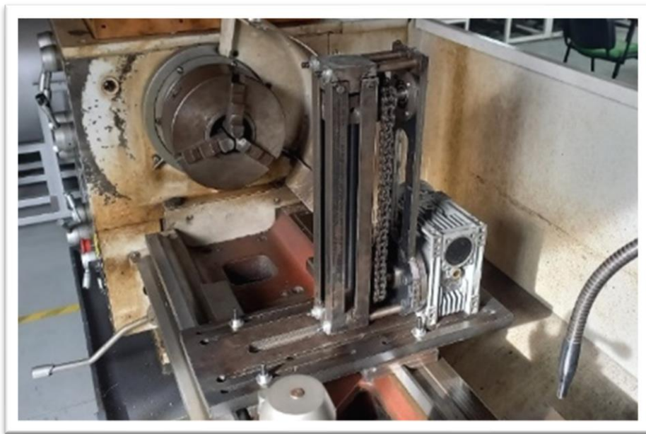
Figura 8.66 Montaje en un torno paralelo con variación en la bancada.
