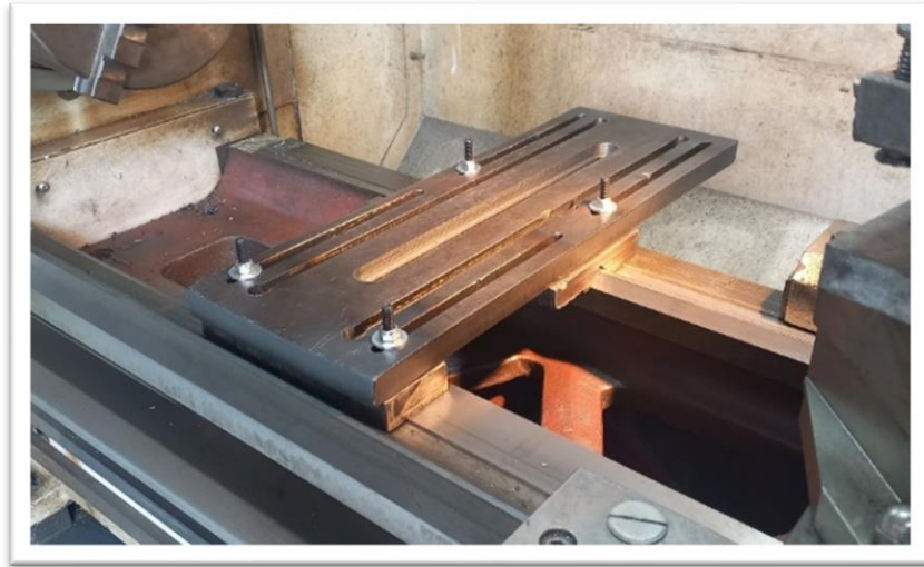
Figura 8.65 Montaje de la base del convertidor en un segundo torno paralelo.
