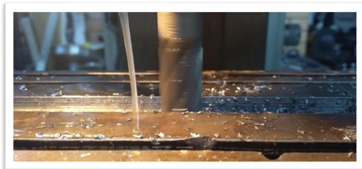
Figura 8.54 Broca escariadora de 1 pulgada y uso de refrigerante.
