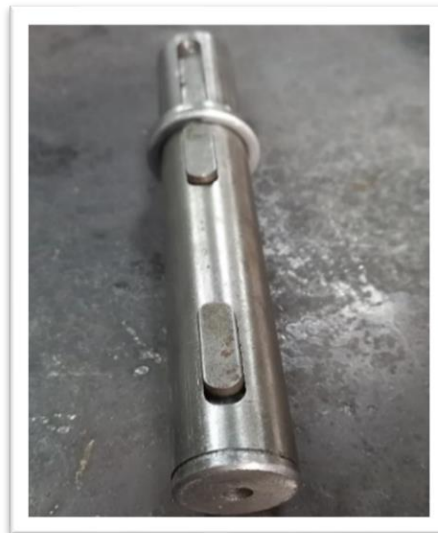
Figura 8.17 Eje de reductor con chavetas y chaveteros.
