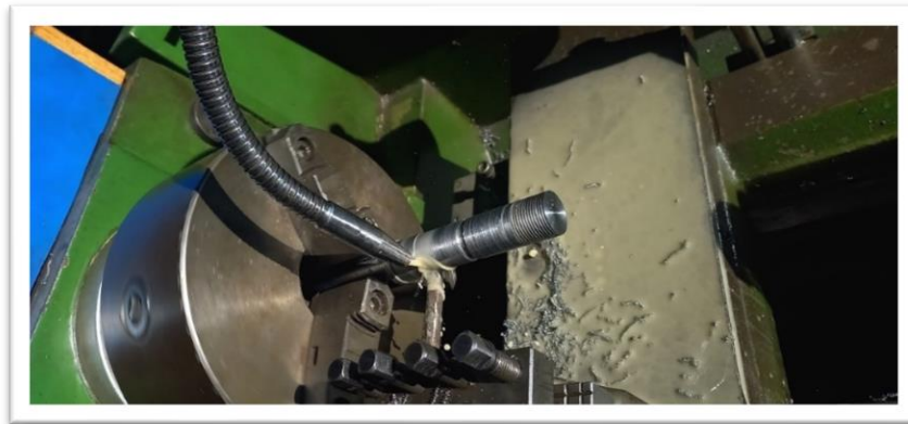
Figura 8.15 Fijación de la pieza e inicio de mecanizado.
