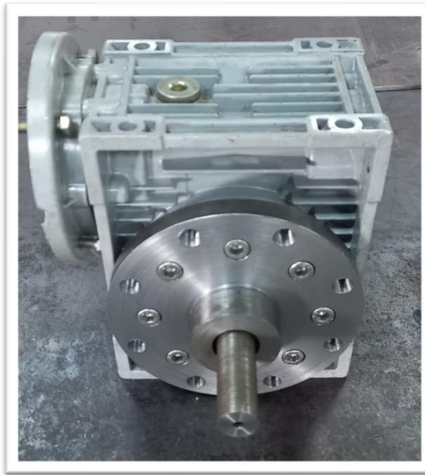
Figura 8.19 Montaje de brida de cuello a caja reductora.
