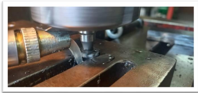
Figura 8.55 Proceso de mecanizado con fresa rotativa.
