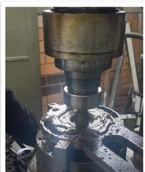
Figura 8.21 Empleo de bailarinas para corte de manera circular.
