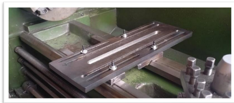
Figura 8.64 Montaje de la base del convertidor en un torno paralelo.
