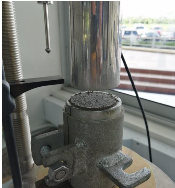
Figura 8.12. Compactación estática del material granular Fuente: Propia
