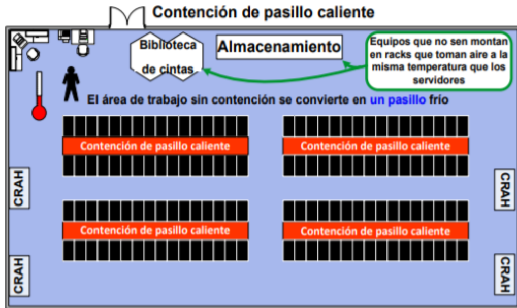
Figura 7. HACS en un plano de data center.
