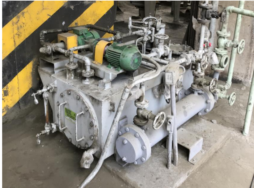
Figura 5. Unidad de lubricación trituradora de clinker
