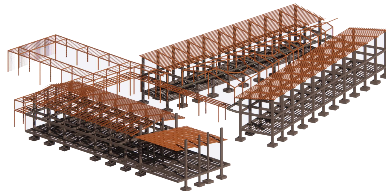
Fig. 54 Isométrico sistema estructural. Juan F. Guerrero. 2022
