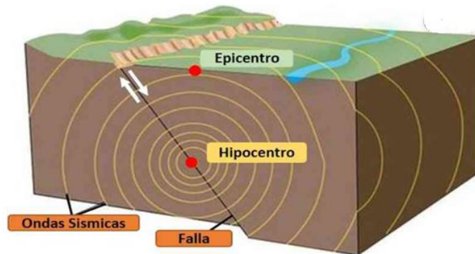
Imagen 13. Ilustración del concepto para la determinación de distancias epicentrales
