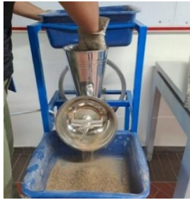
Figura 7 Trituración de la cascara de yuca.
