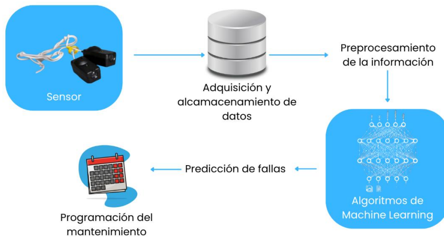
Figura 6. Ecosistema del Machine Learning aplicado al mantenimiento predictivo (basado en la literatura revisada).
