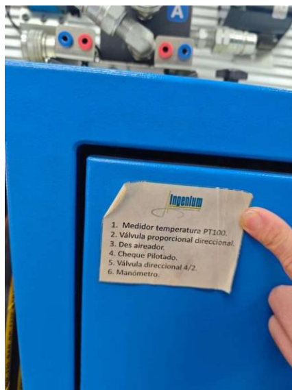
Figura C.1 — Rótulo del fabricante (grupo 1): PT100, válvula proporcional direccional, desaireador, cheque pilotado, válvula direccional 4/2 y manómetro.
