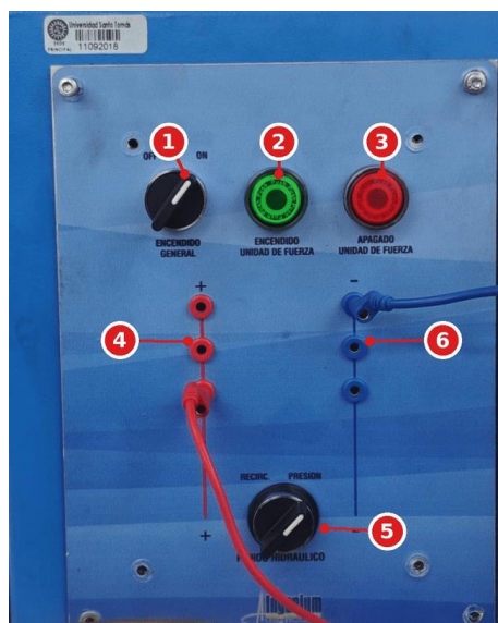
Figura A.1 — Tablero de encendido del banco: 1 encendido general, 2 encendido de la unidad de fuerza, 3 apagado de la unidad de fuerza, 4 línea de 24 VDC, 5 muletilla de fluido (recirculación/presión), 6 línea de 0 VDC.
