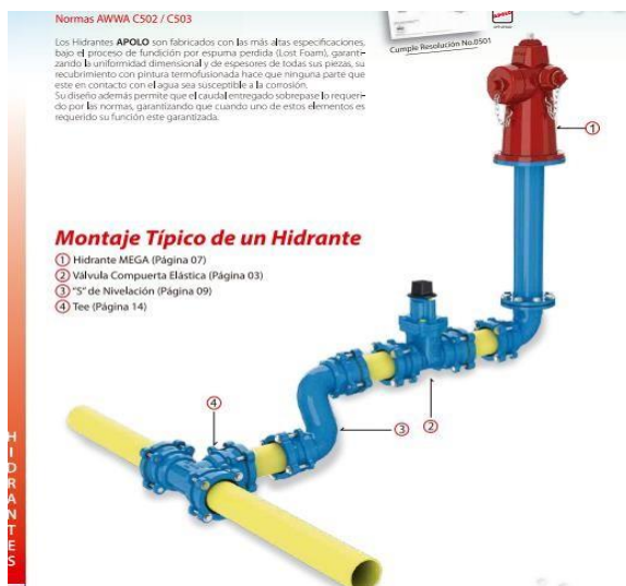
Figura 44. Partes conexión hidrante a cotizar
