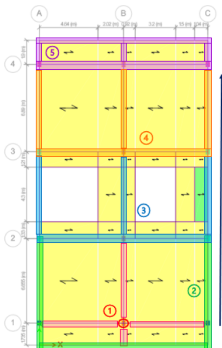
Figura 18. Hipótesis de secuencia de falla
