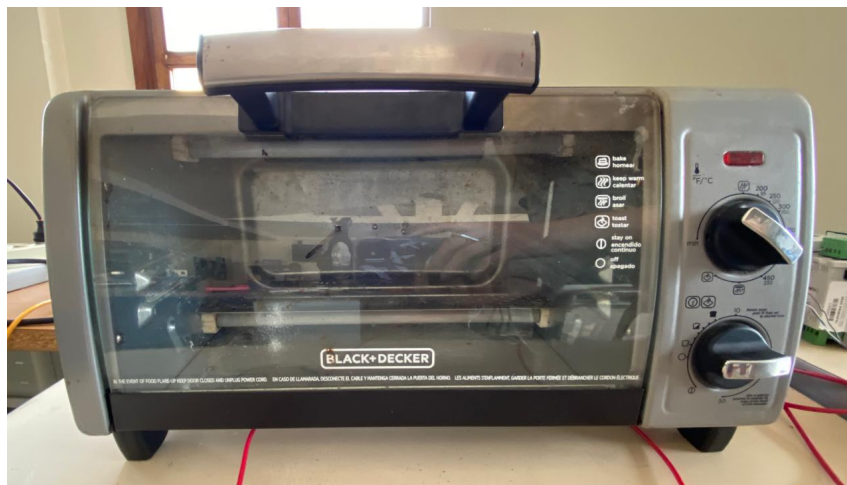
FIGURA 23: Horno eléctrico utilizado como carga variable tipo PTH. Fuente: Autores.
