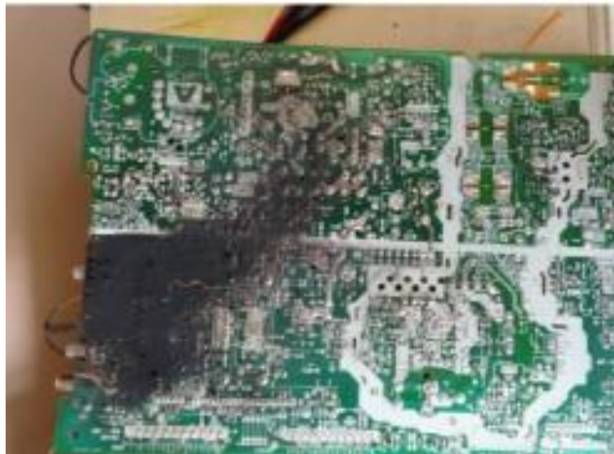
Figura 23. Descarga atmosférica (Rayo)
