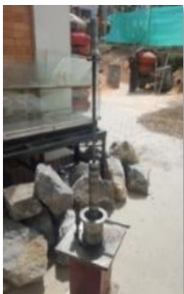
Figura 25. Montaje en Pedestal de la Mezcla Densa en Caliente, para Compactación.
