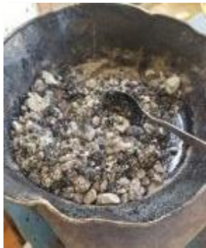
Figura 21. Mezcla Agregados y Cemento Asfáltico
