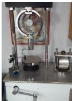
Figura 20. Prensa de ensayo Marshall.
