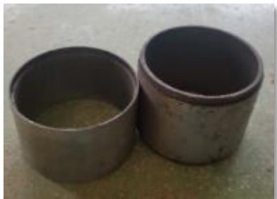
Figura 17. Molde de compactación 4" diámetro y 3" de altura
