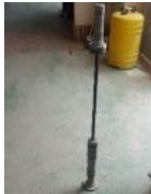
Figura 18. Martillo de compactación con zapata circular (peso 10 lb - altura de caída 18")
