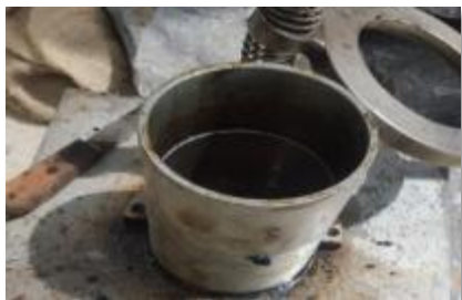
Figura 23. Molde Listo para Agregar Mezcla Densa en Caliente
