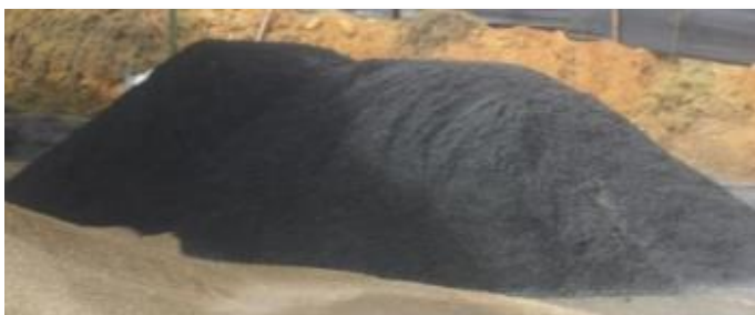
Figura 3. Llenante Mineral, Planta de Asfalto Beinco S.A.S
