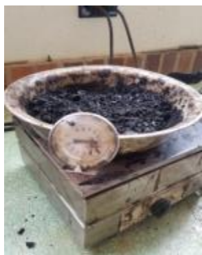
Figura 22. Mezcla Agregados y Cemento Asfáltico a Temperatura de 110°C
