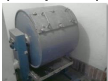
Figura 9. Máquina de los Ángeles. Desgaste de Material
