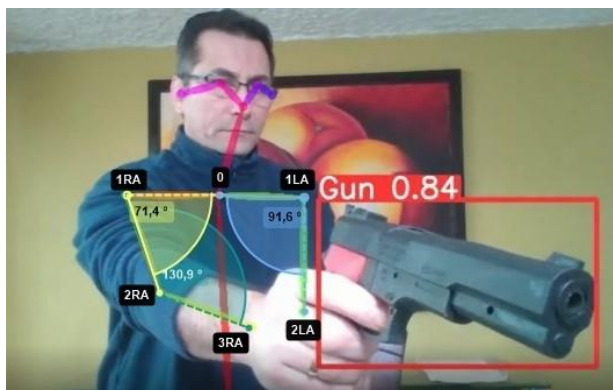
Figura 25. Relación de puntos de articulación y ángulos brazo extendido al frente. Fuente: Propia
