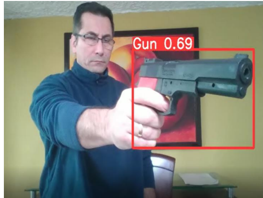
Figura 17. Detección de arma de fuego con postura brazo extendido frontal. Fuente: Propia
