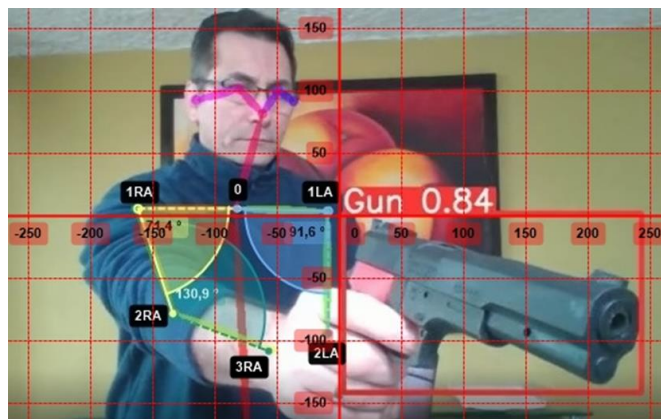
Figura 27. Relación de puntos de articulación, ángulos y coordenadas brazo extendido al frente. Fuente: Propia
