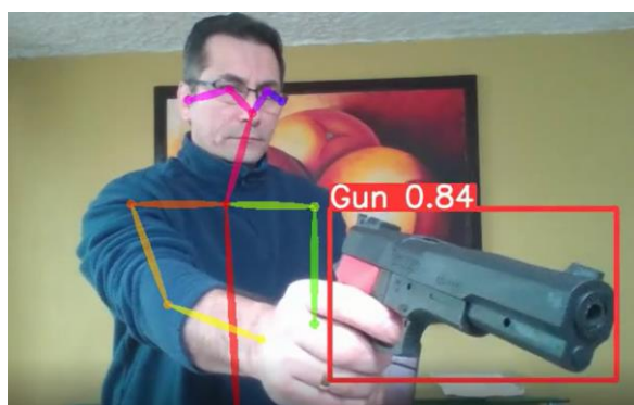
Figura 21. Estimación postural con arma de fuego/brazo extendido. Fuente: Propia
