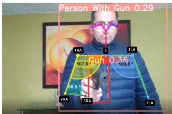
Figura 24. Relación de puntos de articulación y ángulos brazo semiflexionado al frente. Fuente: Propia
