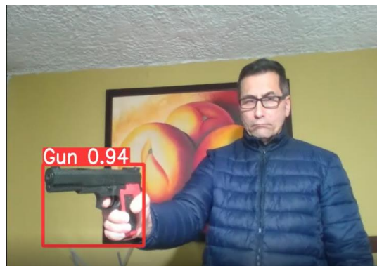
Figura 18. Otra detección de arma de fuego con postura brazo extendido frontal. Fuente: Propia
