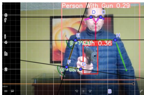
Figura 22. Medición de ángulos brazo semiflexionado. Fuente: Propia
