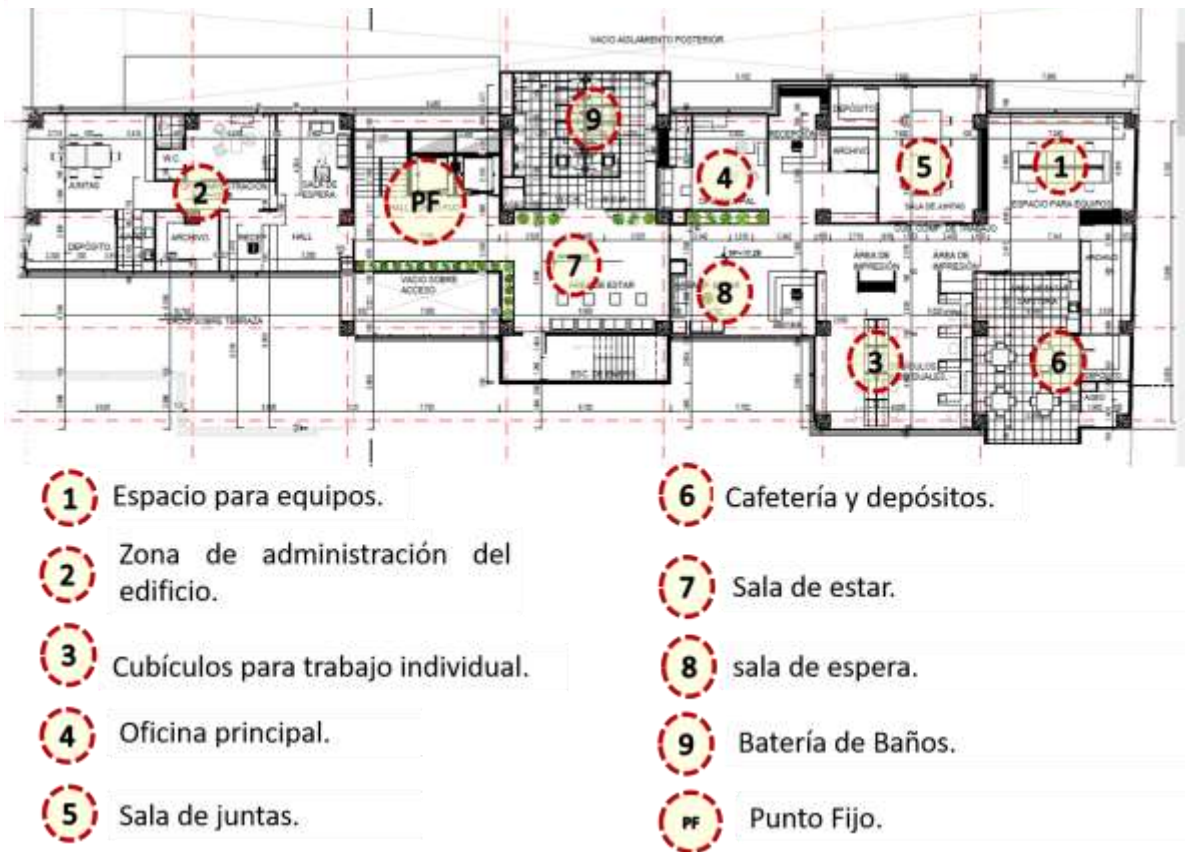
Figura. 42 Planta de séptimo piso
