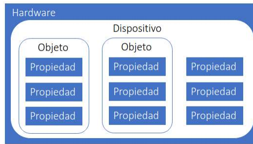
Figura 5.5: Estructura objetos BACnet y sus propiedades en hardware. Fuente: autores.
