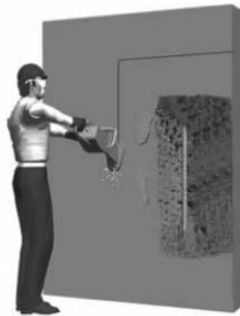
Figura 66 Procedimiento de tratamiento: corte del área (Emmons, 2012, pág. 5)
