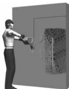
Figura 54 Procedimiento de tratamiento: corte del área (pág. 5)
