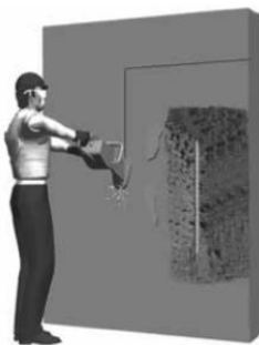
Figura 63 Procedimiento de tratamiento: corte del área (pág. 5)
