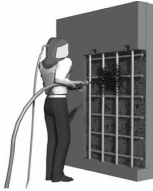
Figura 56 Procedimiento de tratamiento: limpieza del óxido o corrosión (pág. 5)
