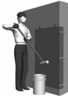
Figura 61 Procedimiento de tratamiento: curado y acabados (pág. 7)
