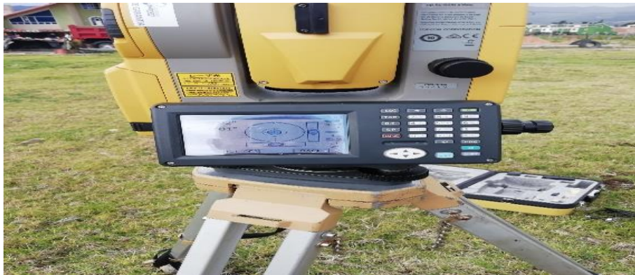
Ilustración 76: Nivelación de estación electrónica del equipo.
