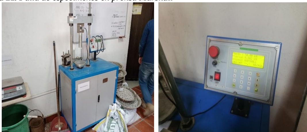
Figura 21. Falla de especímenes en prensa Marshall
