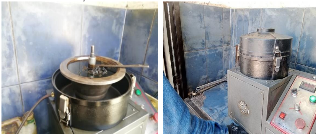
Figura 14. Extracción de asfalto
