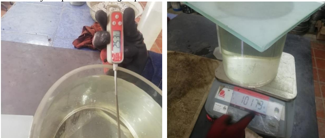
Figura 24. Peso y temperatura del agua para densidad de Rice
