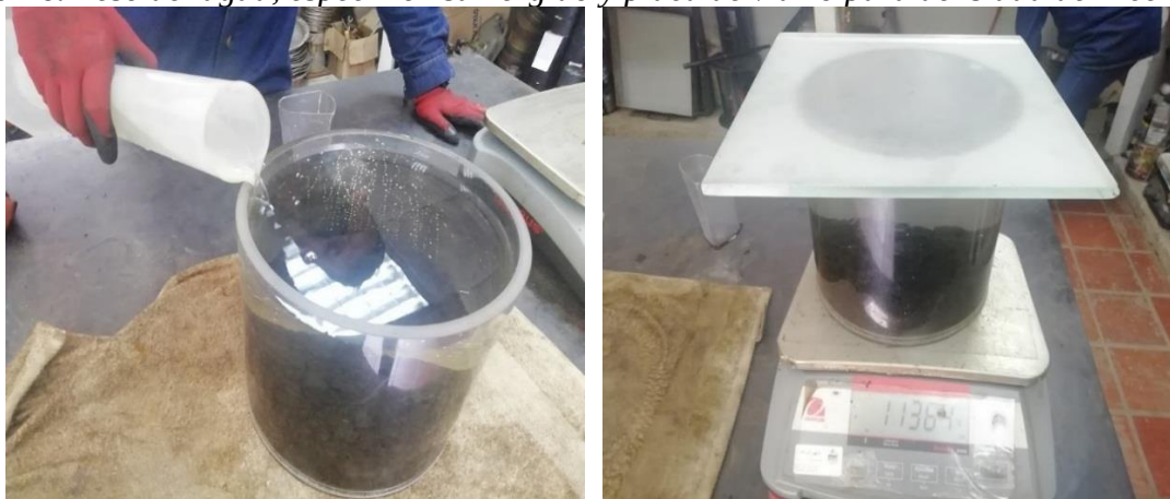
Figura 26. Peso del agua, espécimen sumergido y placa de vidrio para densidad de Rice
