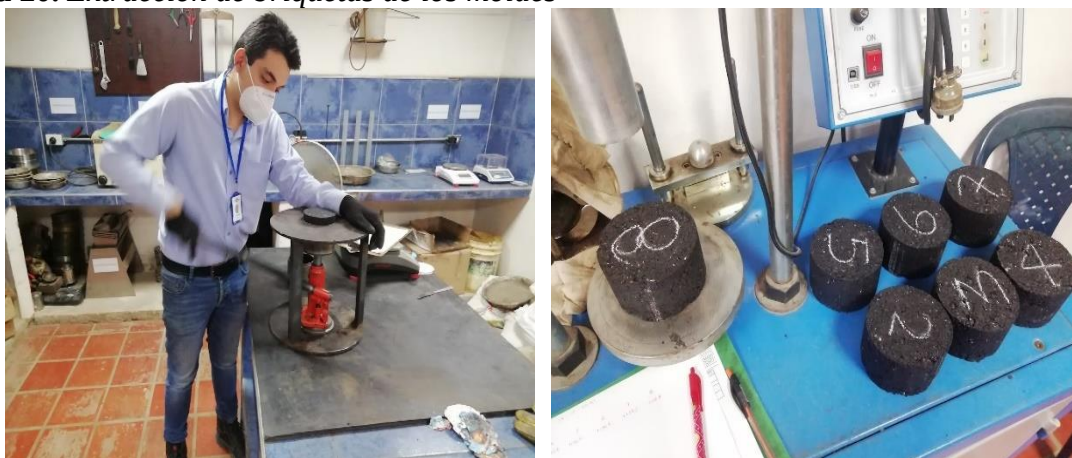
Figura 20. Extracción de briquetas de los moldes
