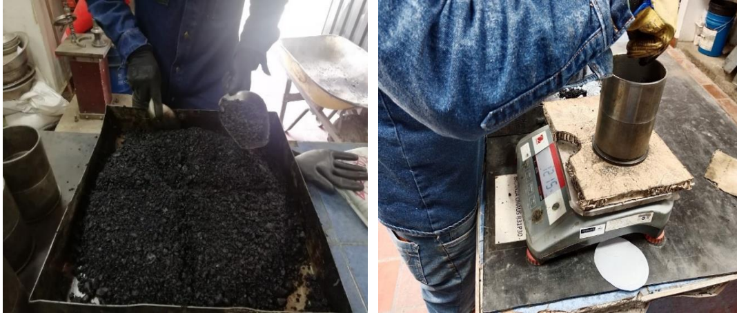
Figura 17. Preparación de moldes para briquetas
