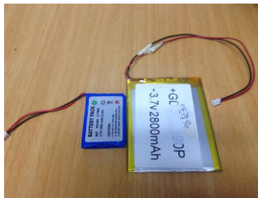
Figura 5. Batería 3.7 V (1000 mAh y 2800 mAh) para aplicaciones de redes de sensores
