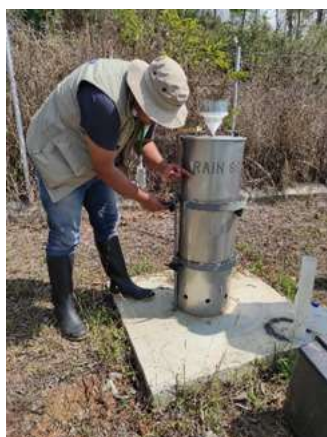
Figura 16. Recolección de aguas lluvias en colector ubicado en estación meteorológica
