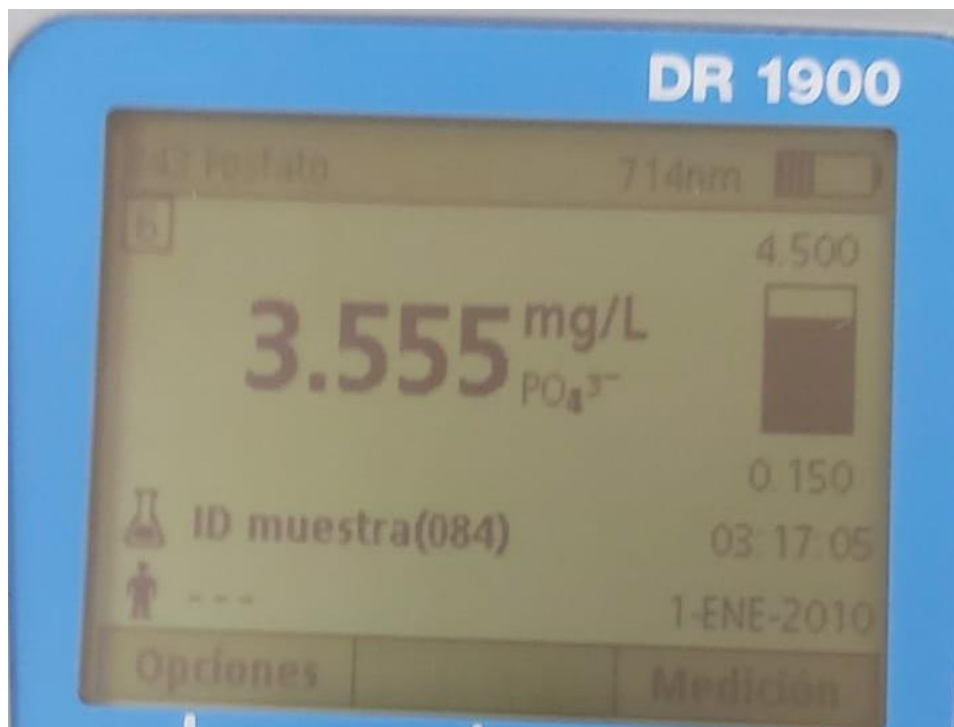
Figura 117. Medición en el equipo DR 1900 de la muestra humus solido dilución al 10%
