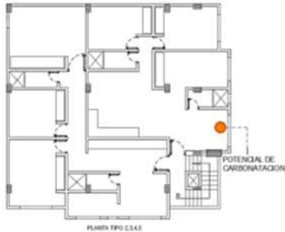
Ilustración 14. Extracción de potencial de carbonatación (Mosquera, 2020).
