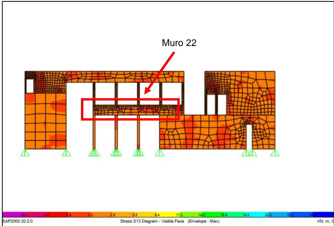
Figura 9-3. Detalle esfuerzos en el elemento 22.
