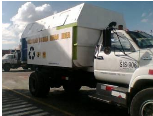
Figura 15. Vehículo recolector con compartimentos para varios tipos de residuos. [15]
