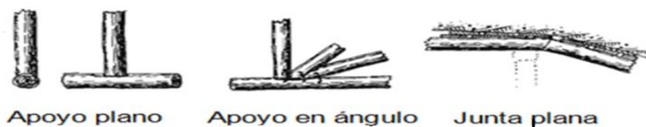
Figura 41 Sistemas de sostenimiento en método tradicional. Modificado de Reyes, 2011.
