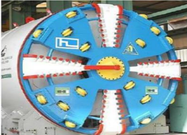
Figura 43 TBM – Hidroescudo. Bohórquez Néstor, 2.013.
