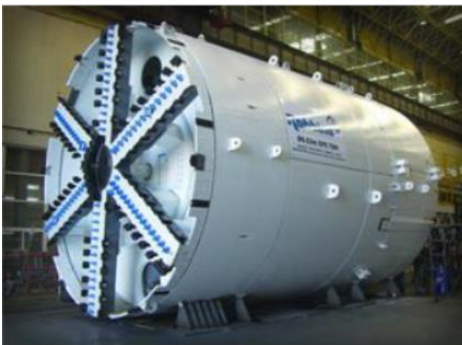
Figura 44 TBM- Balance de Presión de Tierras Cerrado (EPB). Bohórquez, 2.013.
