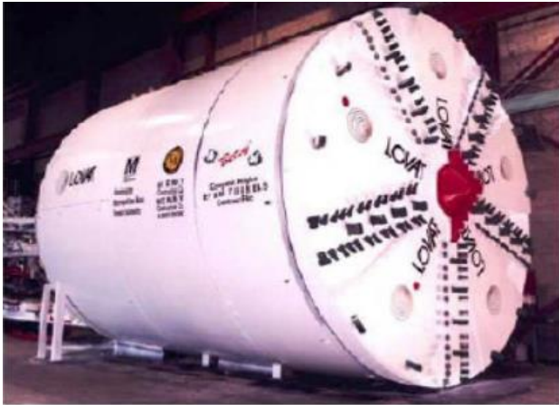
Figura 45 Tipo Excavación Mecánica Abierto. Bohórquez Néstor, 2.013.
