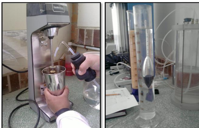
Figura 7-2 Granulometría por hidrómetro – Norma INV. E-124-07
