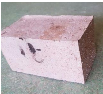
Exudación del vidrio para 10% T 950°C
