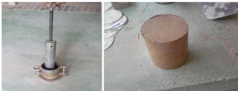
Figura 8-5 Humedad óptima de compactación. Ensayo Proctor estándar.
