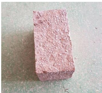
Exudación del vidrio para 20% T 1050°C
