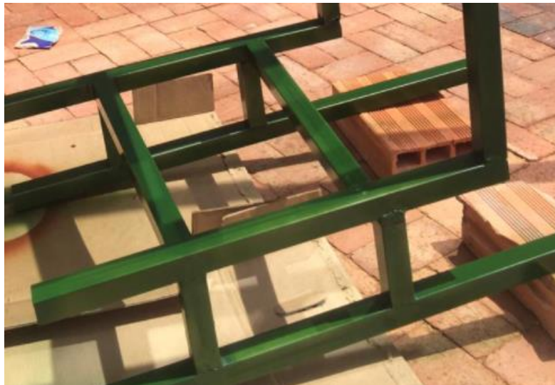
Figura 35. Soportes de rigidez para la estructura.
