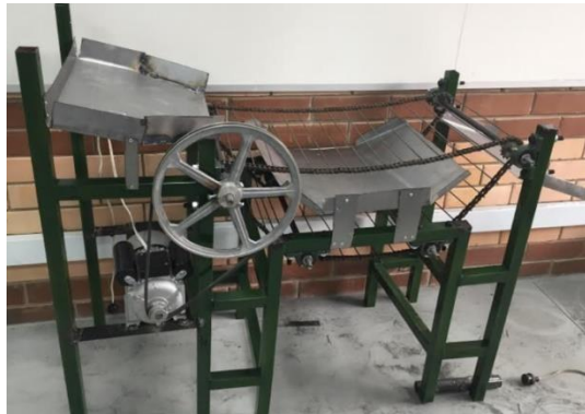
Figura 44. Máquina clasificadora cebolla cabezona por tamaños.
