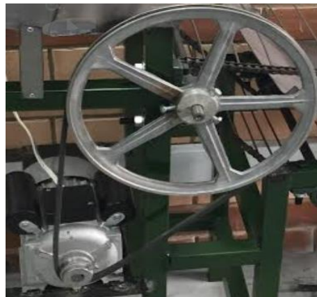
Figura 40. Ensamble del eje y polea.
